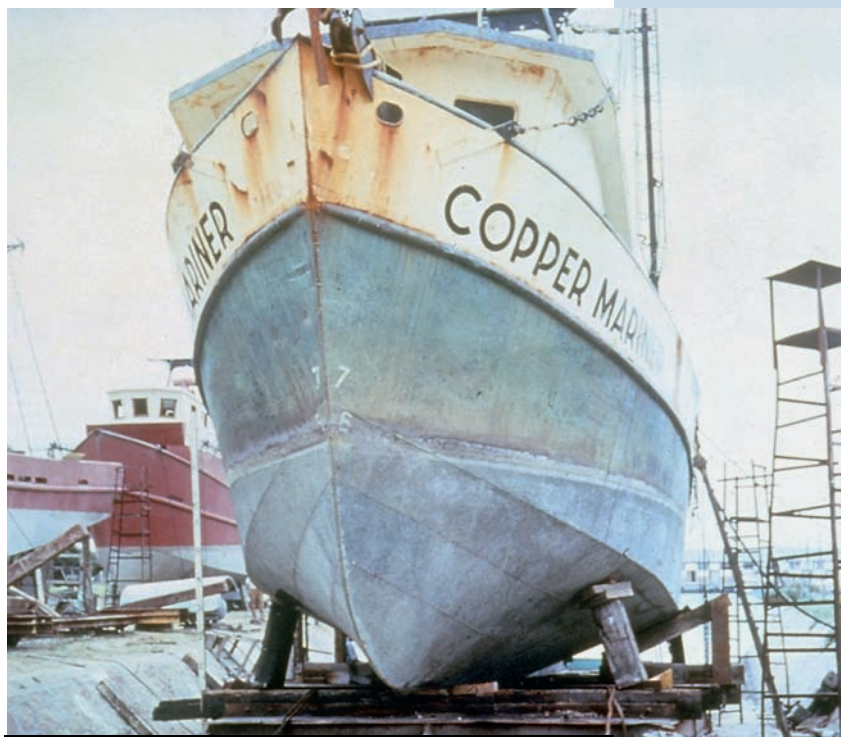
FIG|03 La Copper Mariner, una delle prime barche con scafo in cupronickel, dello spessore di 6 mm. È stata varata nel 1971.
