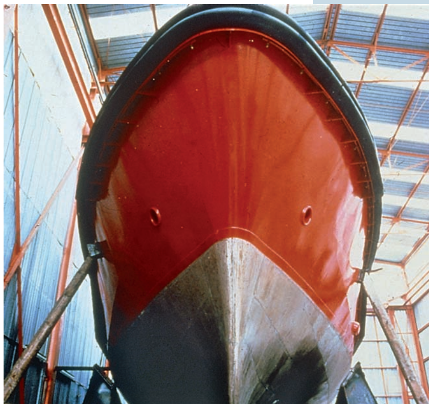
FIG|02| Imbarcazione per i Vigili del Fuoco: la chiglia è ricoperta da lastre sandwich di 6x3 m e uno spessore di 6 mm di acciaio e 2 mm di cupronickel uniti per laminazione.
